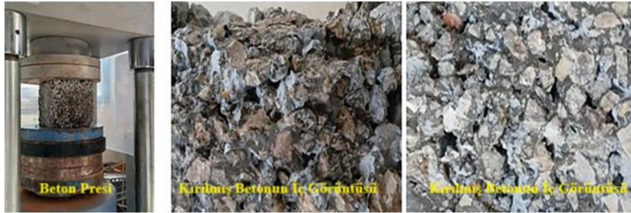
Görsel 4. Basınç dayanımı testi ve Kırılmış numunelerinin iç görünümü
