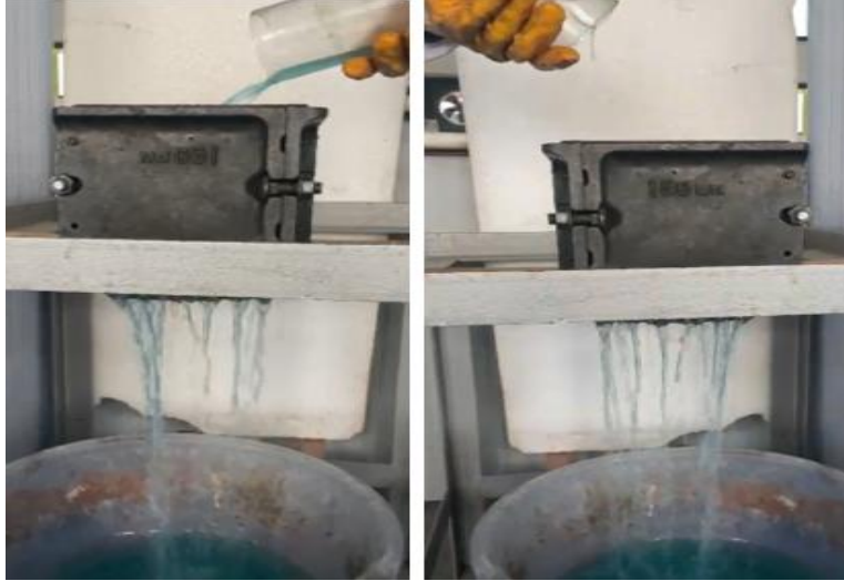
Görsel 5. Betonun geçirimsizlik testi
