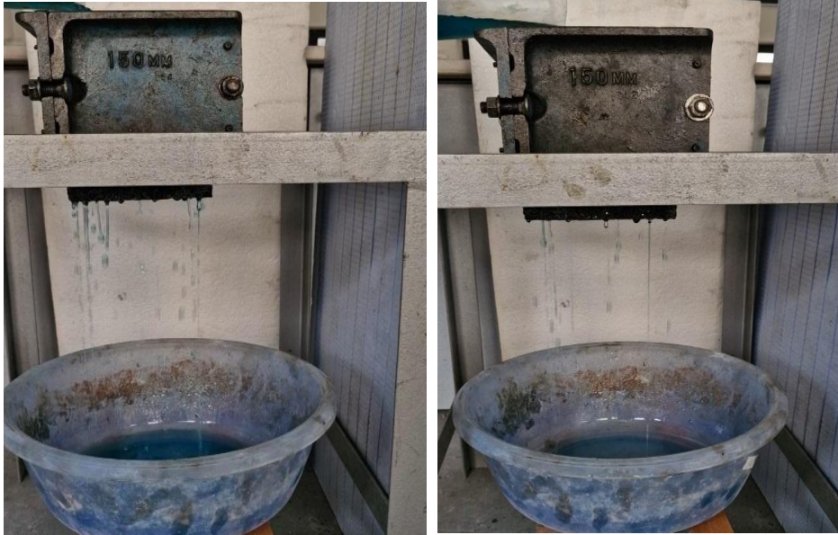
Görsel 3. Geçirimsiz betondan suyun geçiş görüntüsü
